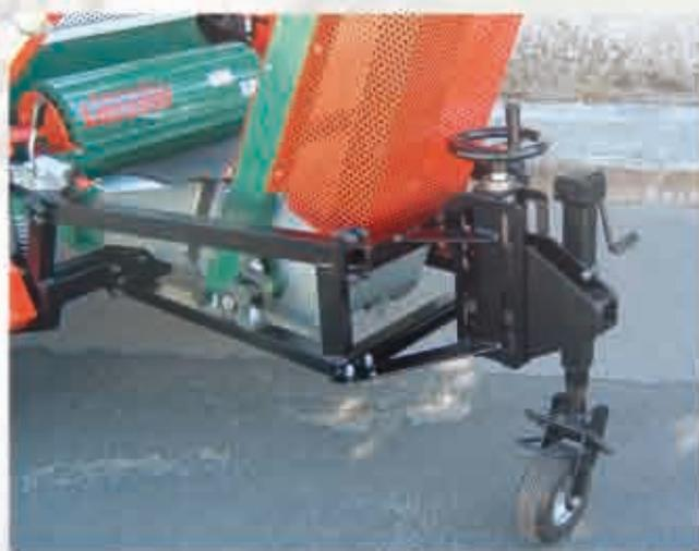
sistema di regolazione livello macchina
